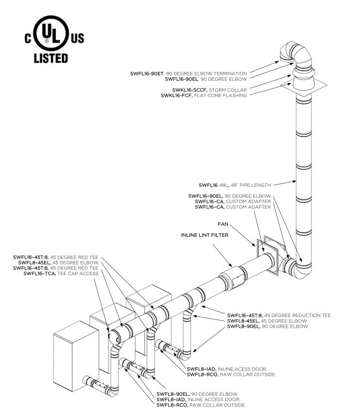
SAMPLE 11 - SWFL CHIMNEY LINER 12" SWFL CHIMNEY LINER
