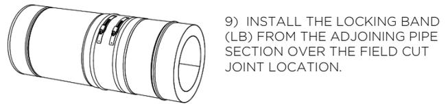
9) INSTALL THE LOCKING BAND (LB) FROM THE ADJOINING PIPE SECTION OVER THE FIELD CUT JOINT LOCATION.
